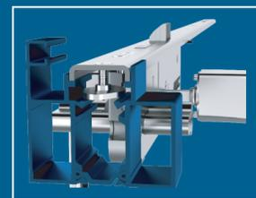
La contre-plaque est fournie dans la position qui permet l'insertion immédiate de la serrure sur la rainure du profilé.
