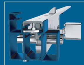
Il suffit de visser pour faire tourner la contre-plaque à l'intérieur de la rainure et fixer la serrure sur le profilé.
