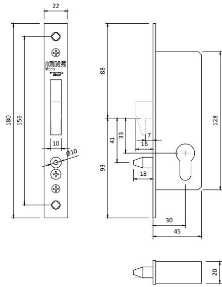
› Fechadura para alumínio, testa em inox com entrada de cilindro, gancho e espigão.
