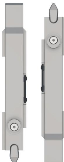
› Kit de fecho bidirecional para a segunda folha com ou sem oscilobatente. Duas ponteiras ligadas por duas réguas a um mecanismo de alavanca central. Acionando a alavanca, as duas ponteiras abrem ou fecham simultaneamente. Incorporam dois pontos de fecho com regulação.
