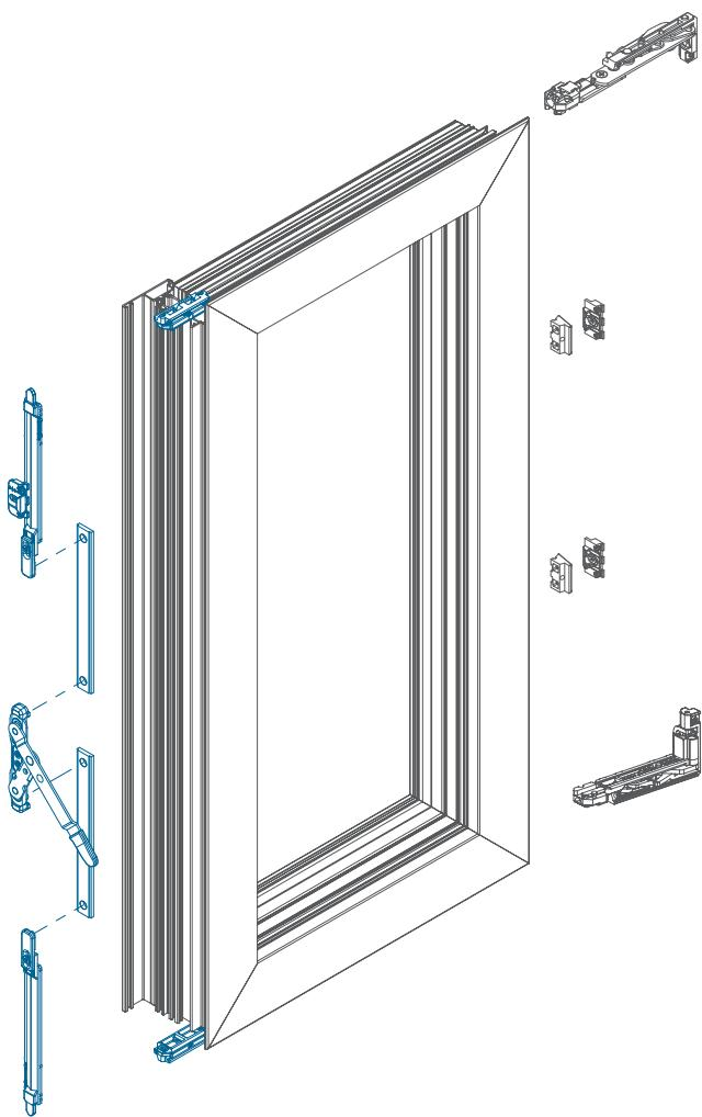
› Kit de fecho bidirecional invisível para a segunda folha de oscilobatente. Duas ponteiras ligadas por duas réguas a um mecanismo central. Acionando a alavanca, as duas ponteiras abrem e fecham simultaneamente.
