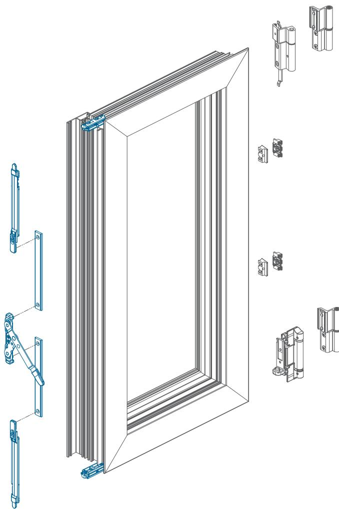
› Kit de fecho bidirecional para a segunda folha de oscilobatente. Duas ponteiras ligadas por duas réguas a um mecanismo central. Acionando a alavanca, as duas ponteiras abrem e fecham simultaneamente.
